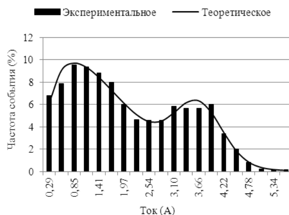
Рис. 8. Экспериментальное и теоретическое распределения реактивного тока 5-ой гармоники
