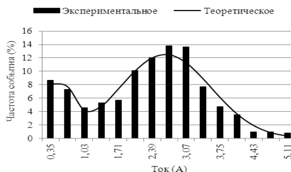
Рис. 5. Экспериментальное и теоретическое распределения активного тока 5-ой гармоники
